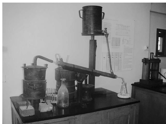
リービッヒの設計したリービッヒ冷却管(ギーセンのリービッヒ博物館にて)。
