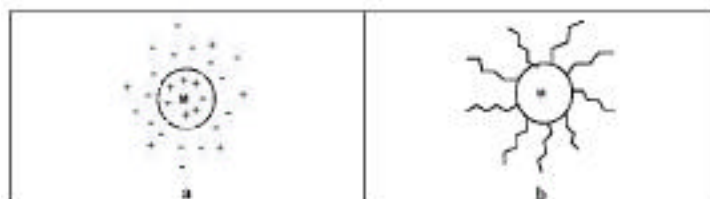
図 1 (a)静電的，及び(b)立体構造的にに安定化された金属粒子(M)の概念図
